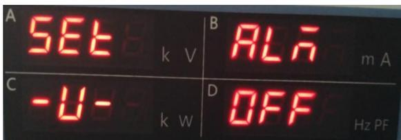
此时通过移位键▶ 来选择是否打开电压上下限报警功能，ON 为打开，OFF 为关闭。
