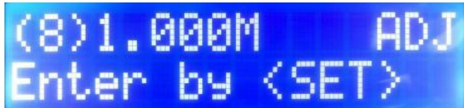
将输出线连接  $1M\Omega$  绝缘电阻，然后按 SET 键，此时仪器会进入绝缘电阻  $1M\Omega$  校准校准模式，再次按 SET 键，仪器会输出检测绝缘阻值，通过“ $\wedge$ ”或“ $\vee$ ”键将仪器显示的电阻值调整至该绝缘电阻的实际值，按 EXIT 保存数据。
