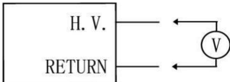
如图将输出线连接至高压表，然后按 SET 键，此时仪器会进入交流电压校准模式，再次按 SET 键，仪器会输出4000V 左右的高压电压，通过“ $\wedge$ ”或“ $\vee$ ”键将仪器显示的电压和高压表显示的电压调到一致，按 EXIT 保存数据。
