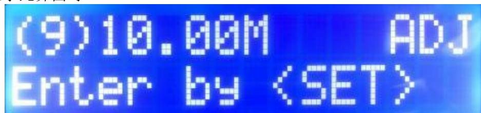
将输出线连接  $10M\Omega$  绝缘电阻，然后按 SET 键，此时仪器会进入绝缘电阻  $1M\Omega$  校准校准模式，再次按 SET 键，仪器会输出检测绝缘阻值，通过“ $\wedge$ ”或“ $\vee$ ”键将仪器显示的电阻值调整至该绝缘电阻的实际值，按 EXIT 保存数据。
