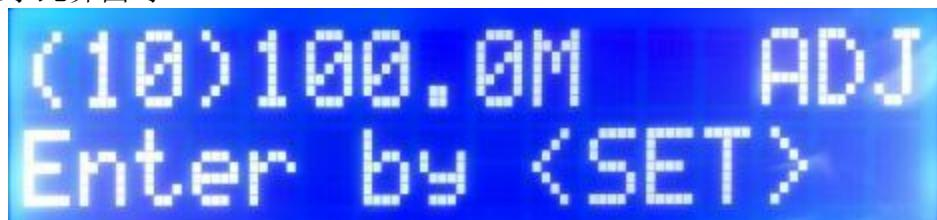
将输出线连接  $100M\Omega$  绝缘电阻，然后按 SET 键，此时仪器会进入绝缘电阻  $1M\Omega$  校准校准模式，再次按 SET 键，仪器会输出检测绝缘阻值，通过“ $\wedge$ ”或“ $\vee$ ”键将仪器显示的电阻值调整至该绝缘电阻的实际值，按 EXIT 保存数据。
