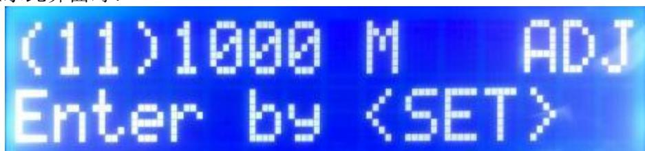
将输出线连接  $1000M\Omega$  绝缘电阻，然后按 SET 键，此时仪器会进入绝缘电阻  $1M\Omega$  校准校准模式，再次按 SET 键，仪器会输出检测绝缘阻值，通过“ $\wedge$ ”或“ $\vee$ ”键将仪器显示的电
