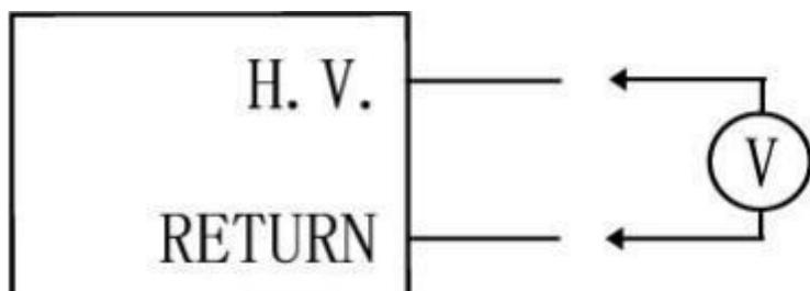
如图将输出线连接至高压表，然后按 SET 键，此时仪器会进入交流电压校准模式，再次按 SET 键，仪器会输出 1000V 左右的高压电压，通过“ $\wedge$ ”或“ $\vee$ ”键将仪器显示的电压和高压表显示的电压调到一致，按 EXIT 保存数据。
