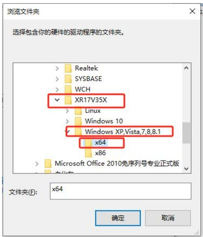
(7) 出现上面红框所示情况表示串口卡驱动已经安装；下面的红色框是还未安装驱动
