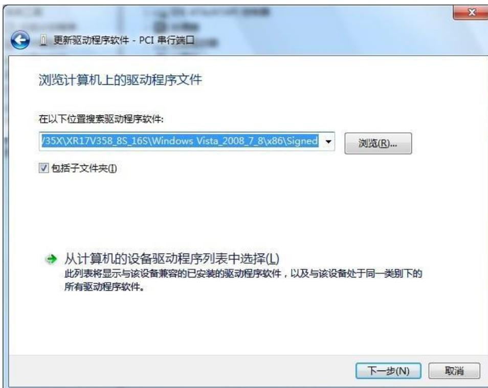
(6) 右击更新驱动程序, 找到 F:\G50198602013A0 串口驱动 2-8 串口
