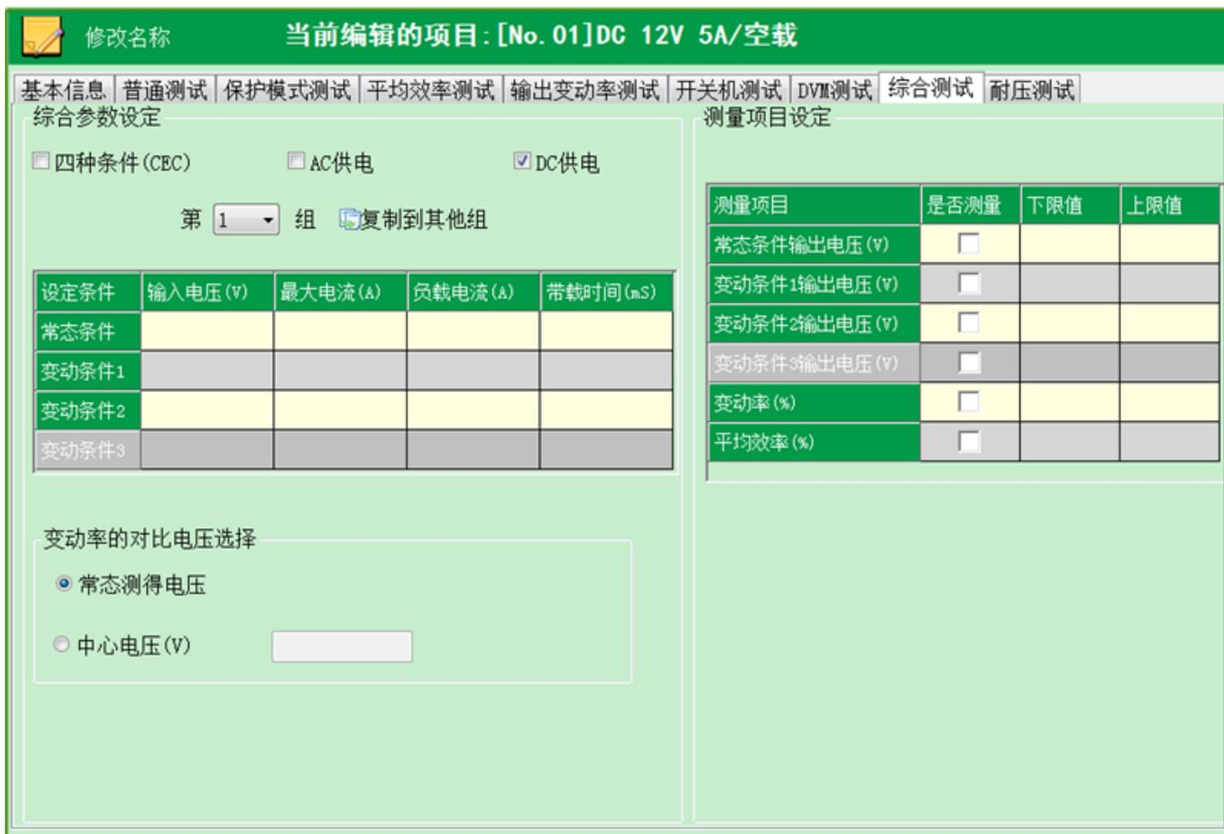
综合测试项目针对 AC-DC 开关电源等产品的电源调整率，负载调整率，和综合调整率。分为常态、变动条件 1、变动条件 2、变动条件 3（需要勾选 4 种条件，测试能源之星），输入电压、频率、负载电流、带载时间可以根据需要单独设定。
