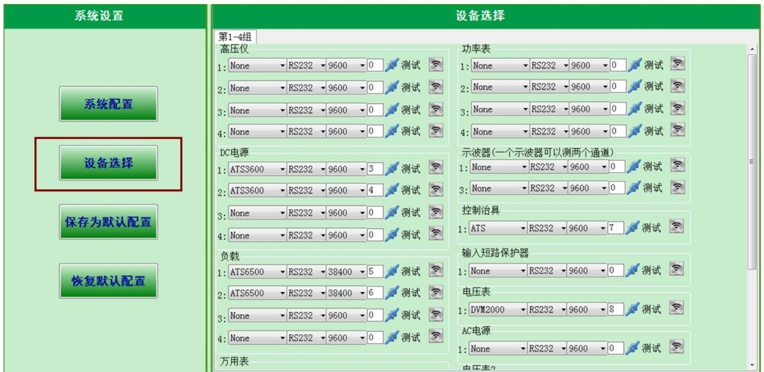
选择系统上配置的硬件对应的名称型号、波特率、COM 号。可点击测试连接，判断该仪器设备是否通讯连接正常。
