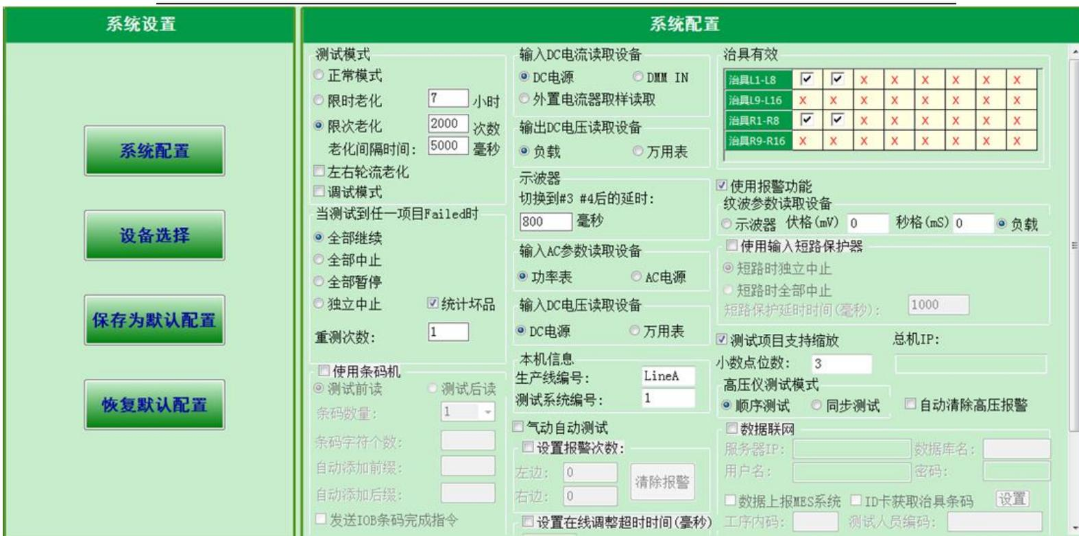
主要有治具通道选择、输入短路保护选择、测试模式选择等。根据实际使用情况选择通道开启或关闭。比如只测试 3 个产品，可关闭一个通道以加快测试速度。建议全部打开。
